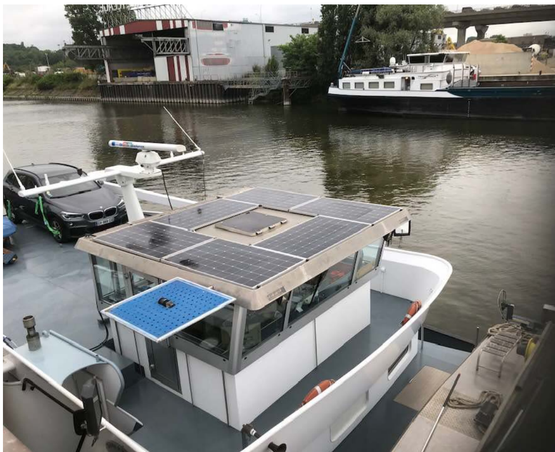
Bateau ULTIMO, automoteur de 1 300 tonnes, équipé de 6 panneaux solaires.
